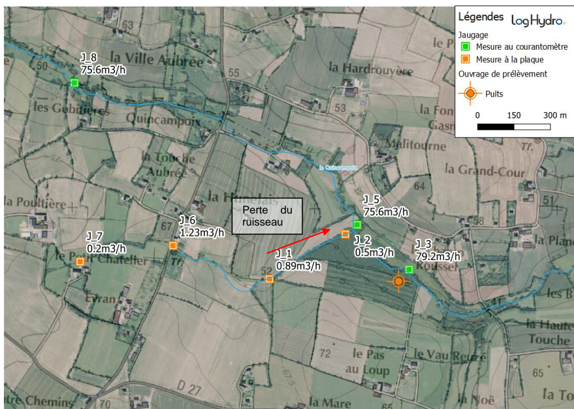
Figure 34 - Implantation et résultats des jaugeages réalisés à la plaque et au courantmètre / Campagne de septembre 2020
