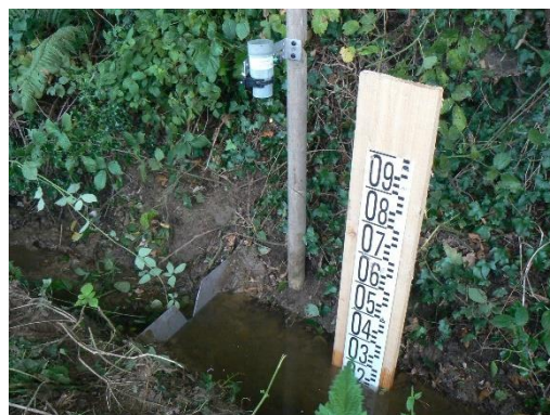
Limnimètre installé sur le Petit Chapelier (L1)
