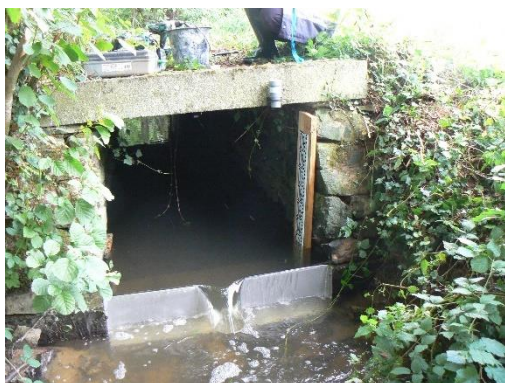
Limnimètre installé sur le Quincampoix (L2)
